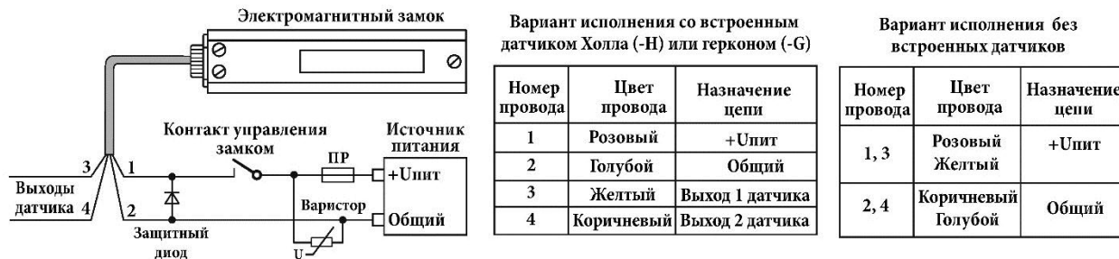
Рисунок 9 - Схема подключения замка
