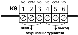
Пример 5. Подключение турникета (турникетный режим)
