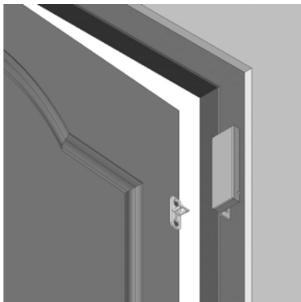
Рис.3 Установка замка на монтажный L- уголок
