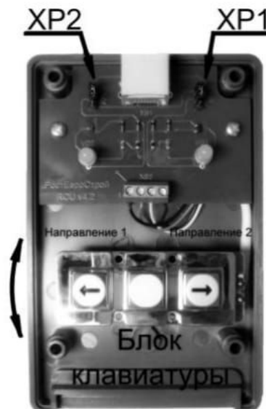
Вид пульта со снятой крышкой
