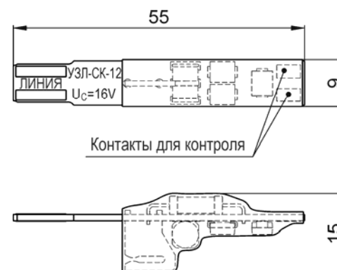
Рис.1 Габаритные размеры УЗЛ-СК-12 (УЗЛ-СК-24)
